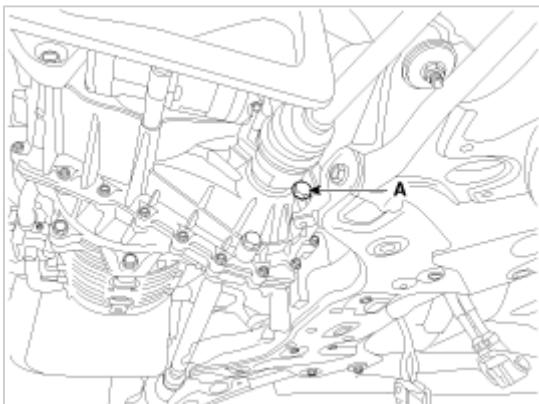
3. 通过加油口填充手动变速器油。
